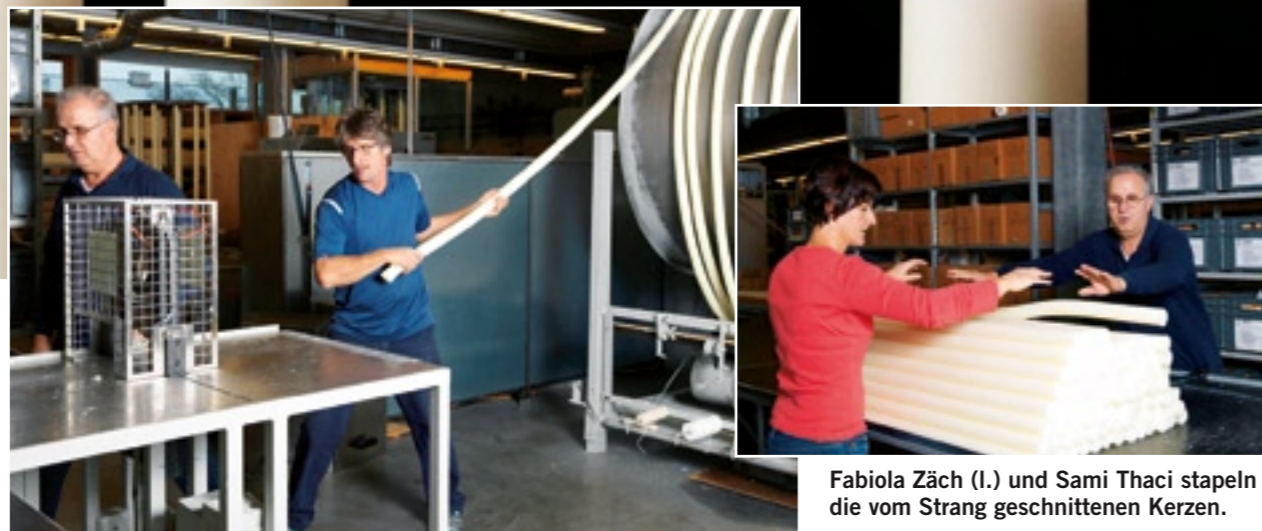
Wachsziehmeister Josef Kobler (r.) holt einen Kerzenstrang von der Zugbank. Sami Thaci assistiert ihm.
