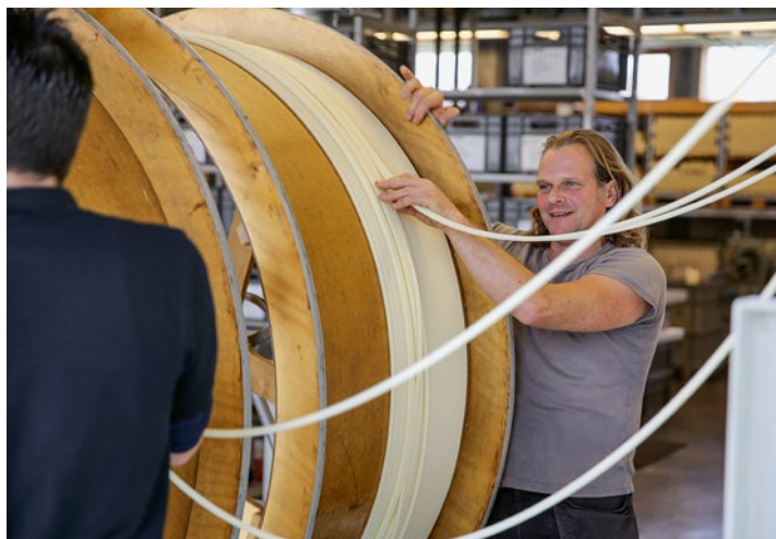
Der gezogene Kerzenstrang wird zunächst auf riesige Spindeln aufgerollt und dann geschnitten.
